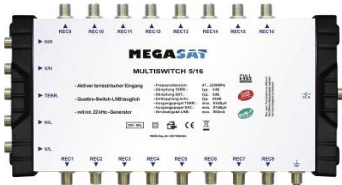
Multiswitch compact, 5 entrées, 16 sorties, compatible LNB Switch quattro, amortissement de raccordement SAT 3 dB, amortissement de raccordement terrestre 3 dB, alimentation secteur inclue
